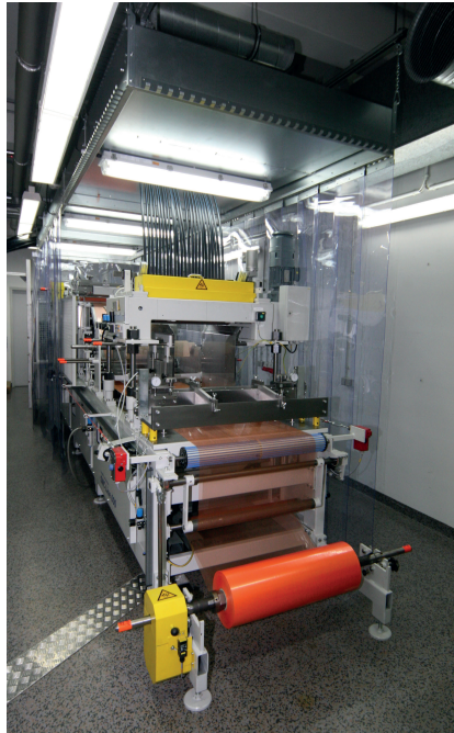
Bild 1. Am IVW wurden auf einer SMC-Fertigungsanlage aus dem mit biobasierten Füllstoffen gefüllten UP-Harz Halbzeuge gefertigt © IVW
